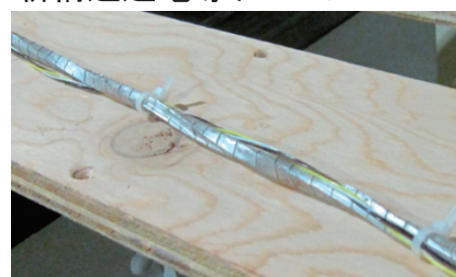
新構造超電導ケーブル
