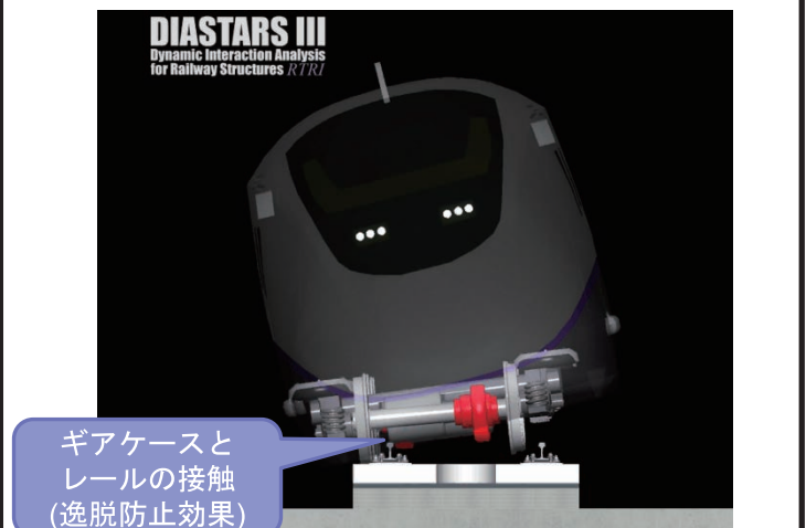
脱線後の輪軸部材と軌道部材の接触解析の例
