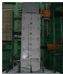
曲げ破壊実験
