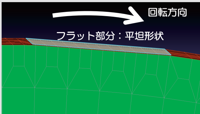
フラット近傍の解析モデル形状 (車輪径：800mm， フラットサイズ：48mm，深さ0.66mm)
