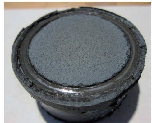
900°C終了後のブレーキ摩擦材外観
