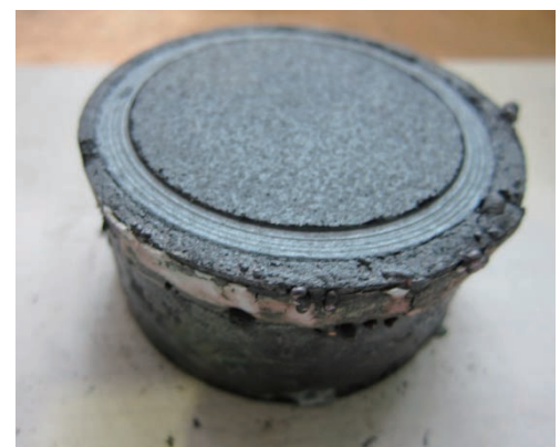
1100°C終了後のブレーキ摩擦材外観
