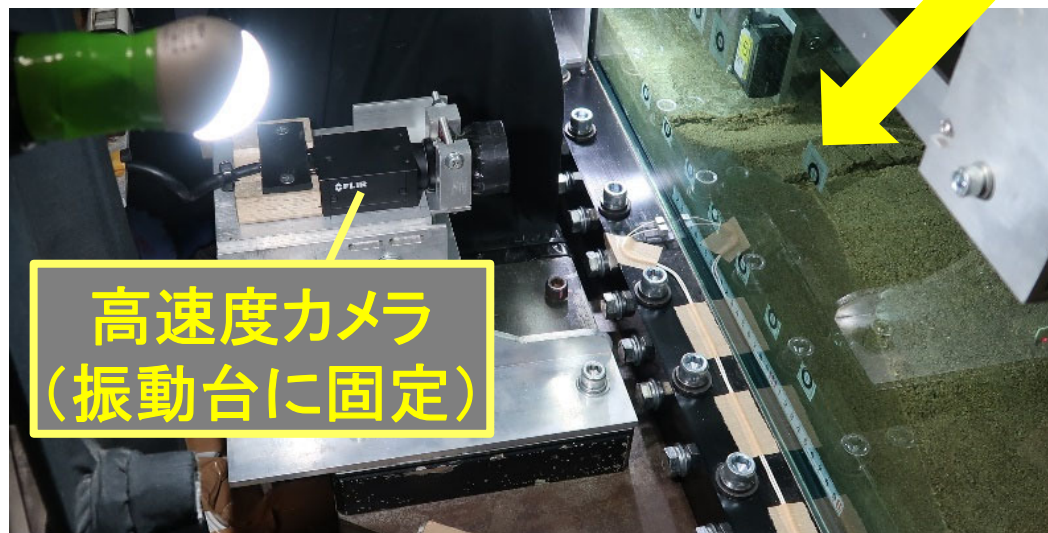
遠心力載荷試験装置 (日本工営)
