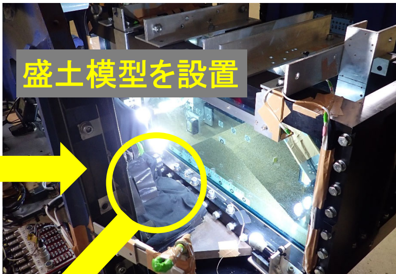
遠心力載荷試験装置 (日本工営)
