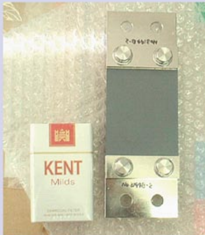
SiC (炭化珪素) 接地抵抗器
