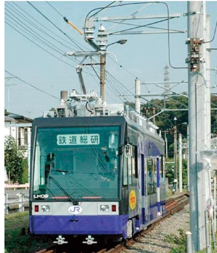
直流1500V剛体架線下でのバッテリー充電電流1000Aによる停車中急速充電
