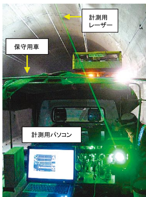
図 トンネル覆工コンクリート調査への適用状況
