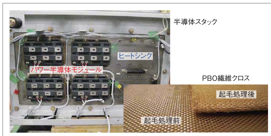
図 高熱伝導特性PBO繊維クロスとパワー半導体スタックへの適用試験
