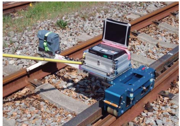
図 レール凹凸連続測定装置の外観
