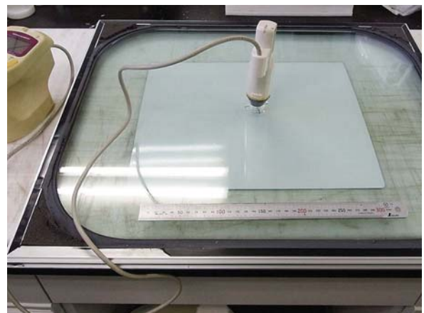
図 実使用品の黄変度測定状況
