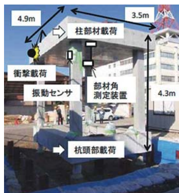
図 模型試験体の載荷試験
