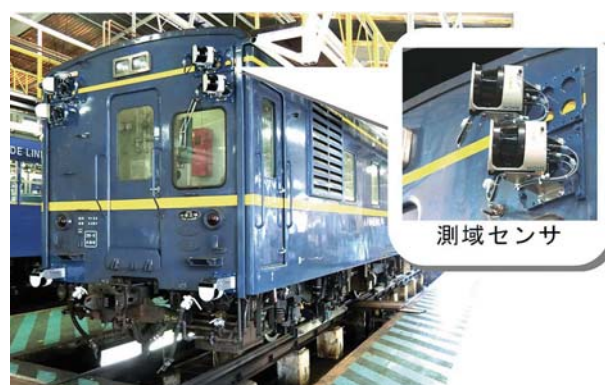
図 車両妻面への測域センサの設置状況
