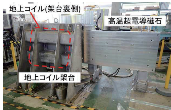
図 電磁加振試験における高温超電導磁石と地上コイルの配置
