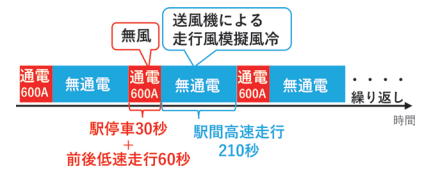
図11 設定した通電・冷却サイクル
