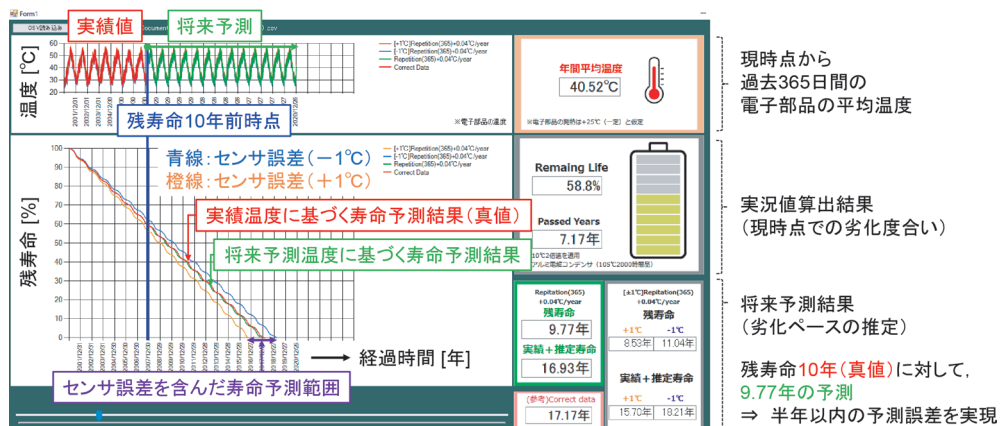
図9 逐次寿命予測手法を実装したツールによるケーススタディ結果（表5の設定条件に基づく）
