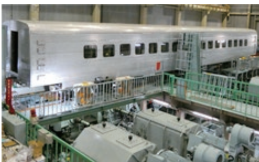
図 11 新幹線型試験車両による車両試験台試験
