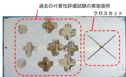
図1 暴露から回収した試験片の一例
