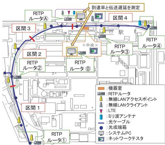
図4 実証試験の機器配置
