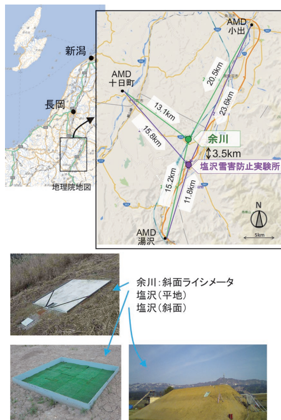
図2 観測点位置とライシメータの設置状況
