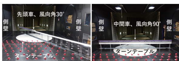
図7 模型設置状況（複線高架橋）
