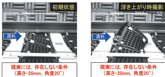
図 17 バラストスクリーンの挙動確認試験 (高さ-20mm, 角度 20°)
