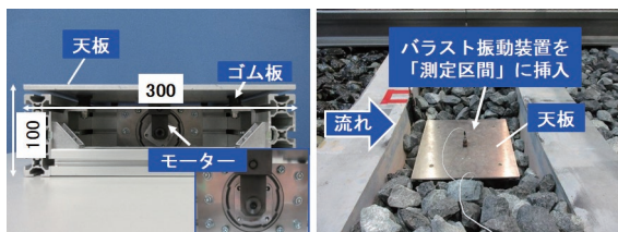
図5 バラスト振動装置（単位：mm）
