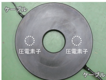
図2 センサ軸ばね防振ゴムの外観
