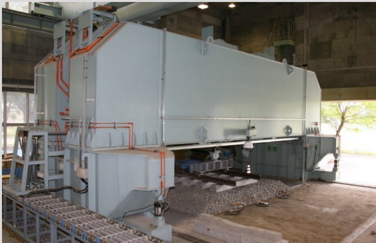
総合路盤試験装置
