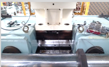
レール曲げ疲労試験の実施状況
