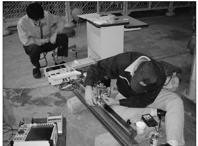
図4 レールトリボメータとの測定値比較実験風景
