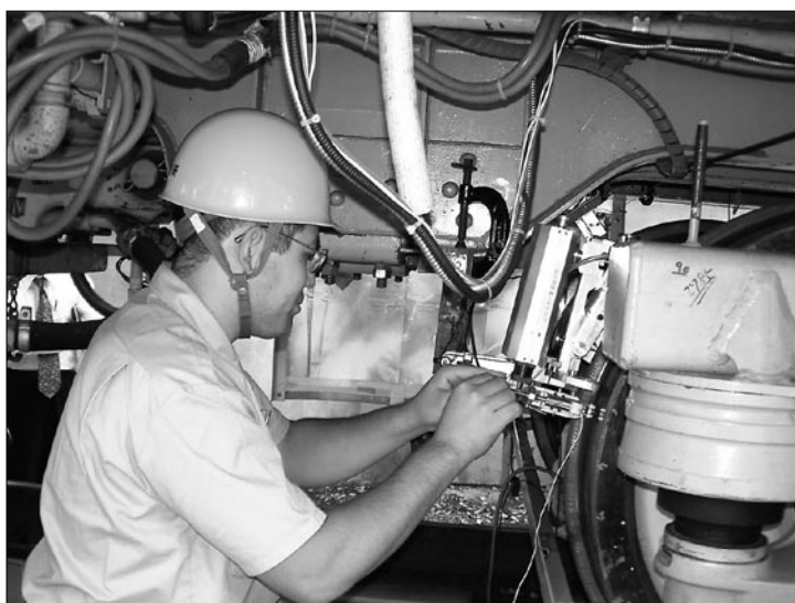
図 1 在姿状態での車輪測定風景
