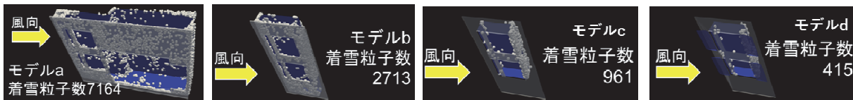
(a) 装置キャビティ内部の着雪分布
