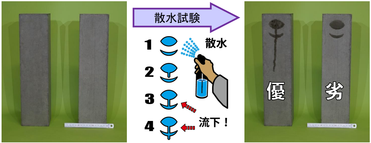
散水試験で可視化されるコンクリート品質の優劣
