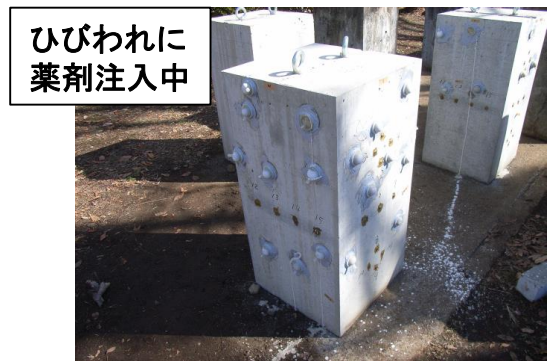
ASRが生じたコンクリート供試体へのひび割れ注入施工の様子
