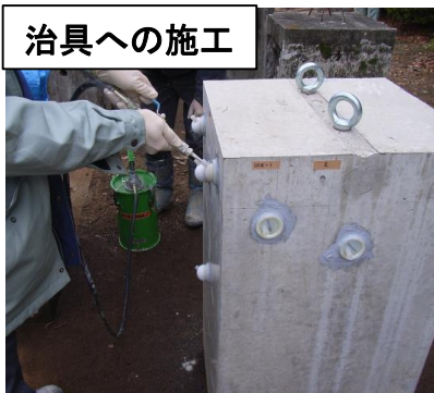
ASRが生じたコンクリート供試体へのひび割れ注入施工の様子
