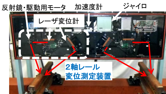
慣性正矢軌道検測装置の2軸レール変位測定装置の機構
