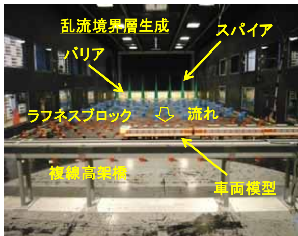
図3-1-15 乱流境界層を用いた風洞試験
