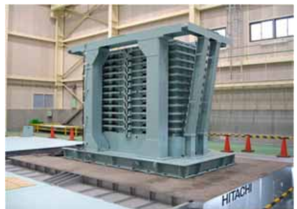
図3-1-5 セン断土槽を用いた振動実験状況
