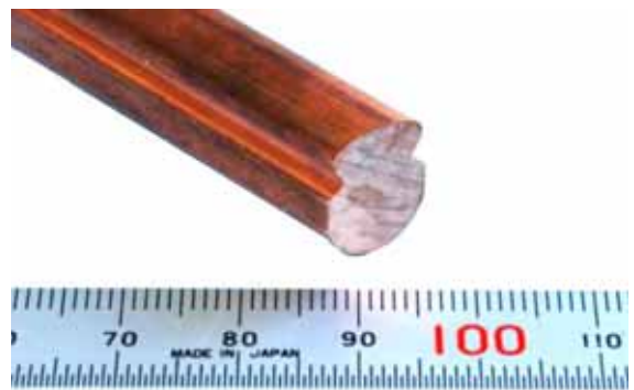
図3-1-6 断面形状を変更したトロリ線の試作品
