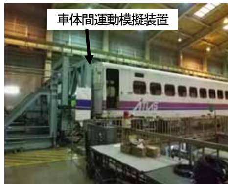
図3-1-3 HILSシステムによる2両編成試験
