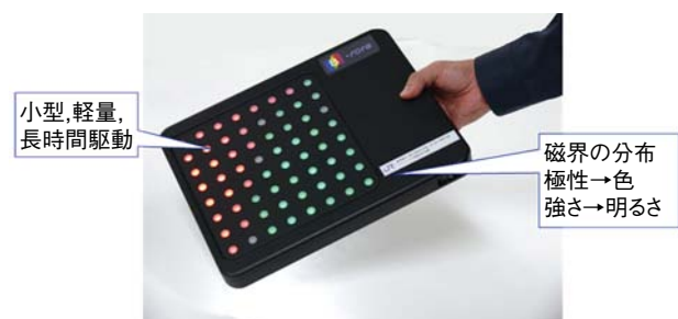
図3-1-26 マトリックス方式磁界測定装置
