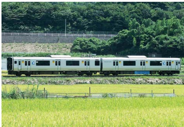
図4-2-1 改造した817系交流バッテリー電車
