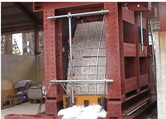
図4-6-1 石積み壁の模型実験
