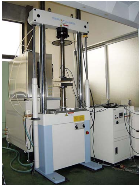
図5-2-1 油圧式防振材料疲労試験機
