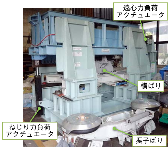
図5-2-2 動揺負荷試験装置
