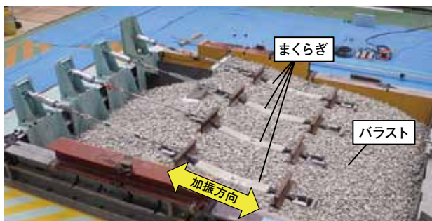
図4-5-1 バラスト軌道の大型振動台試験
