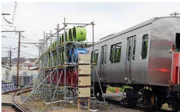
図4-1-1 横風下走行試験状況
