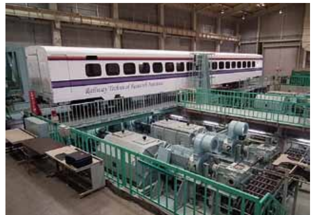
図5-2-1 車両試験装置(1車両試験状態)
