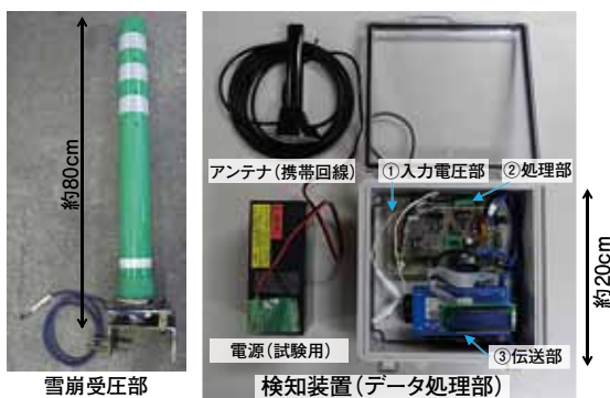
図4-6-1 可搬型雪崩検知装置の試作器
