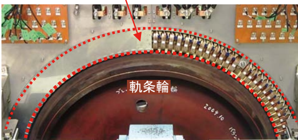
図4-12-1 軌条輪試験用リニアレールブレーキ試験装置
