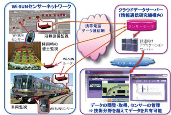
図4-7-2 無線センサーネットワークの実証実験
