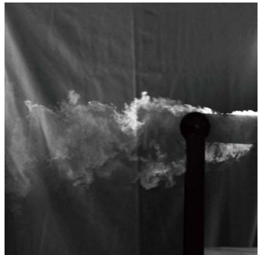
図5-2-4 高速度カメラで撮影した円柱下流の流れ場 (煙による可視化)
