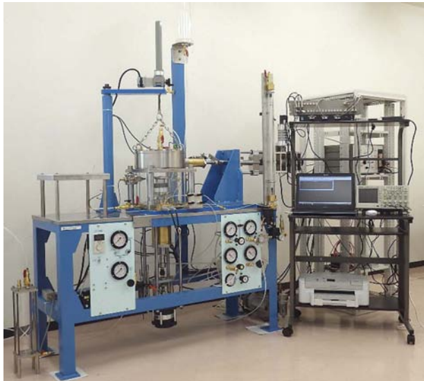
図5-2-2 ハイブリッド地盤応答試験装置
