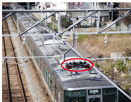
図4-4-2 電車線非接触測定装置の在来線走行試験
