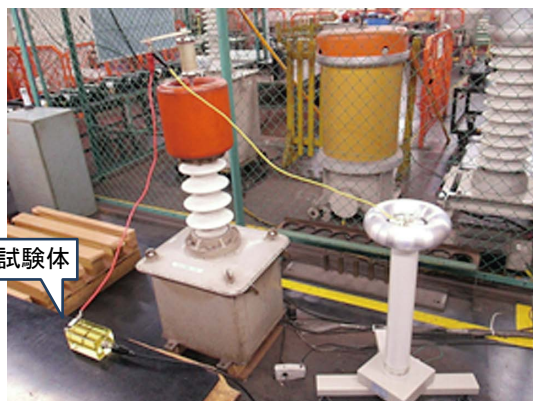
図4-12-1 部分放電発生供試体の絶縁特性試験
