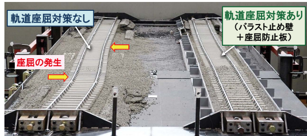
図4-5-2 大型振動台によるバラスト軌道の座屈試験
