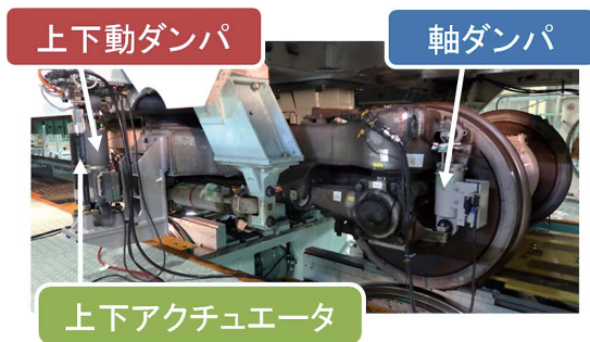
図3-1-7 上下制振制御システム
