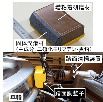
図4-8-2 踏面調整子の構成と実車取付状態
