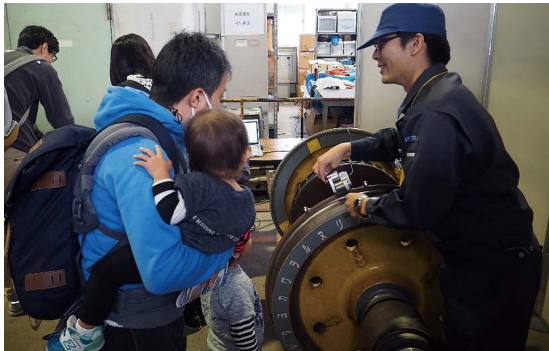
図5-8-2 車輪踏面形状の測定
