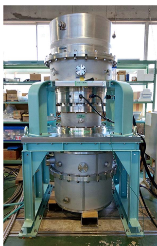
図5-5-6 超電導磁気軸受の信頼性・耐久性評価試験装置
