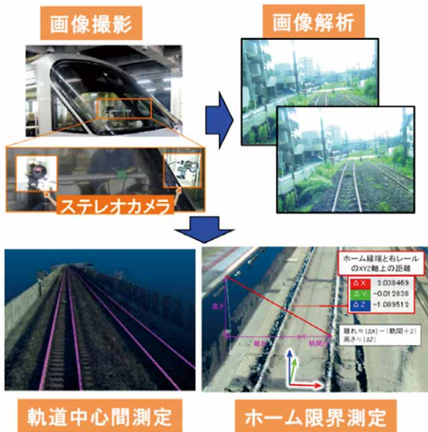
図4-5-2 3次元点群空間による軌道の検査
