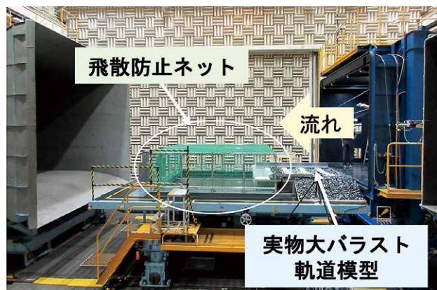
図4-10-1 物体の飛散が可能な風洞試験
