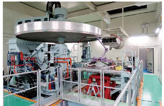
図4-9-1 高速パンタグラフ試験装置による試験の様子
