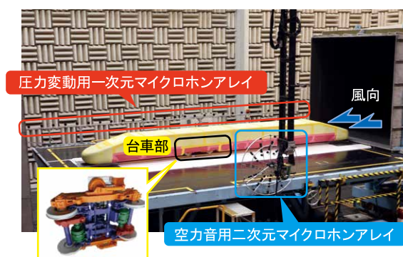
図1 風洞試験における台車部空力音と圧力変動の同時測定
