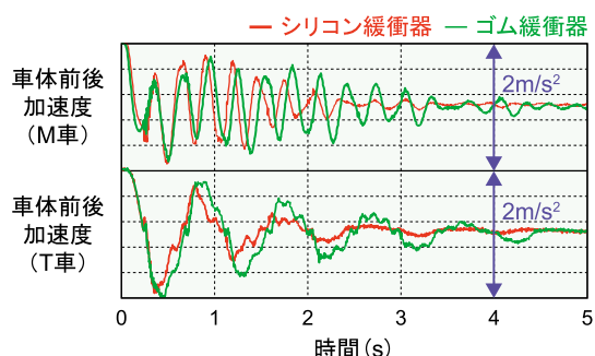
図2 車体前後加速度の低減効果 (M車は制動、T車はブレーキカット)
