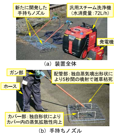
図1 蒸気除草機材の構成
