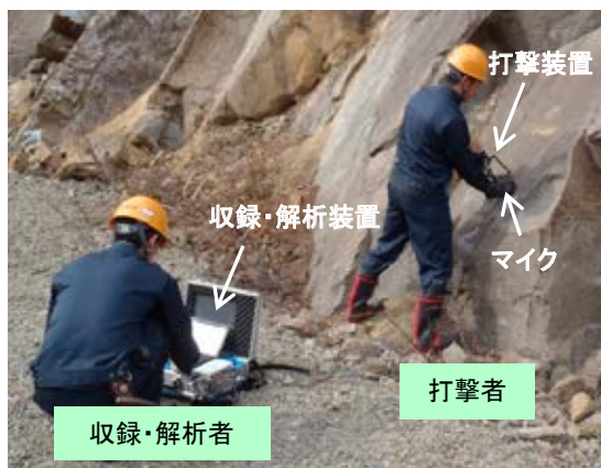
岩盤斜面中の岩塊の打音測定状況
