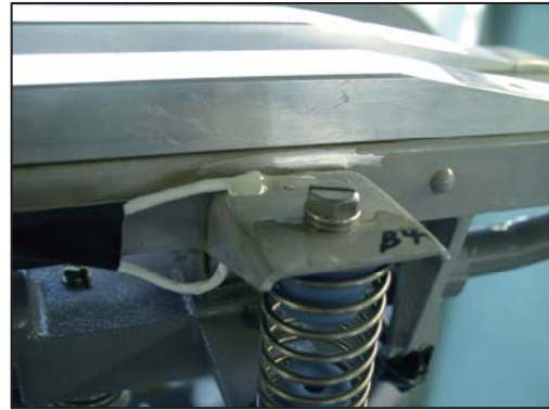
舟体へのセンサ取付例 (在来線)
