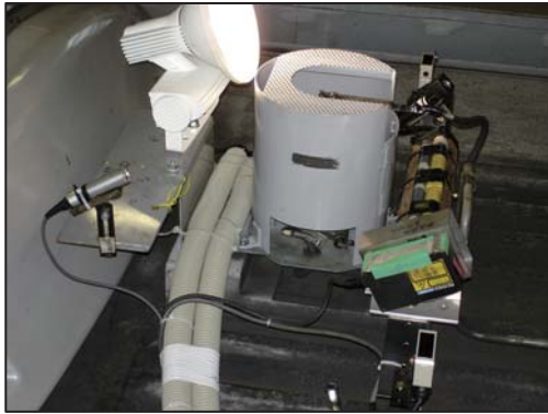
非加圧部へのセンサ取付例 (在来線)
