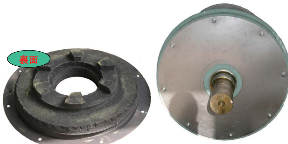
NA形波打車輪に取り付けた試作車輪防音カバー
