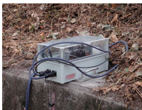
土留め天端に設置した小型起振器
