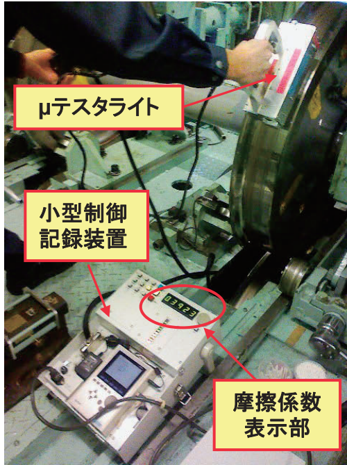
車輪測定状況
