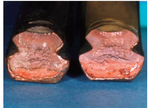
トロリ線の疲労破面
