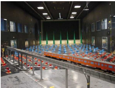
図1 風洞試験による空気力の評価
