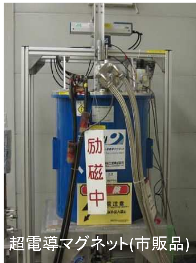
小型超電導マグネットの着磁 (液体窒素充填)
