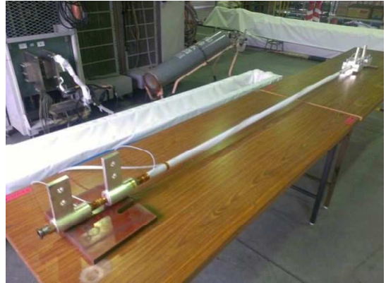
2m級RE系超電導ケーブルの仕様と外観
