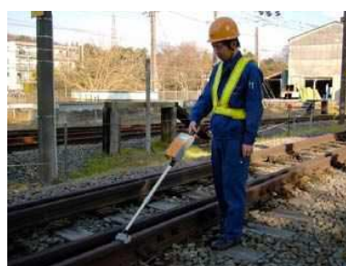
ロッドを付けて連続測定
