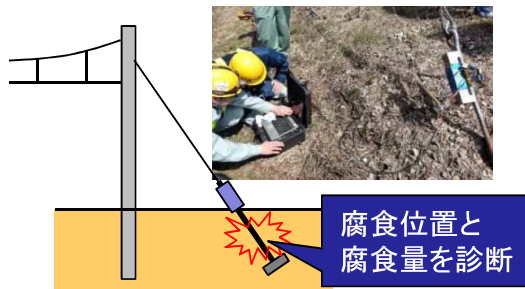
支線ロッド腐食診断 注)
