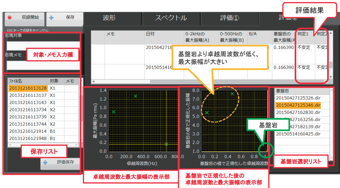
岩盤斜面中の岩塊の安定性評価の例
